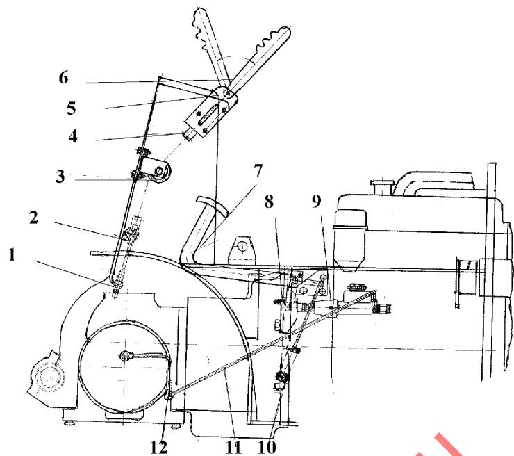
**Рис. 14 Тормозная система**
