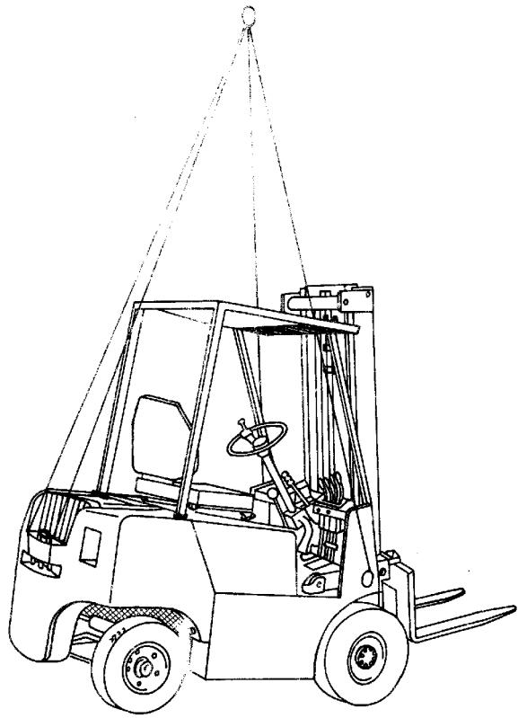
Рис. 30 Схема мест присоединения тросов при транспортировке погрузчика
