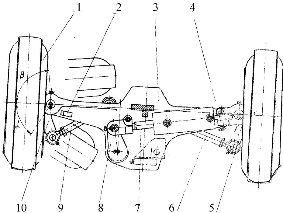
**Рис. 31 Схема регулировки углов поворота управляемых колес**
