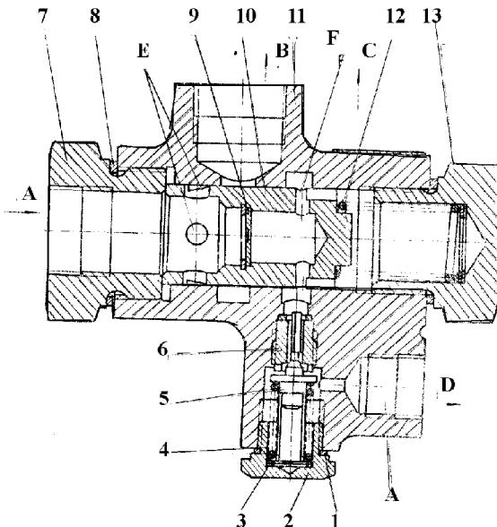
**Рис. 25 Регулятор дебита**
