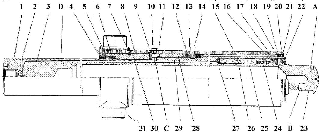
**Рис. 23 Телескопический цилиндр**
