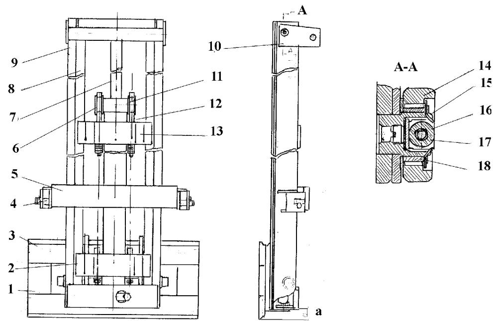
Рис. 16 Грузоподъемное устройство (8562.2)
