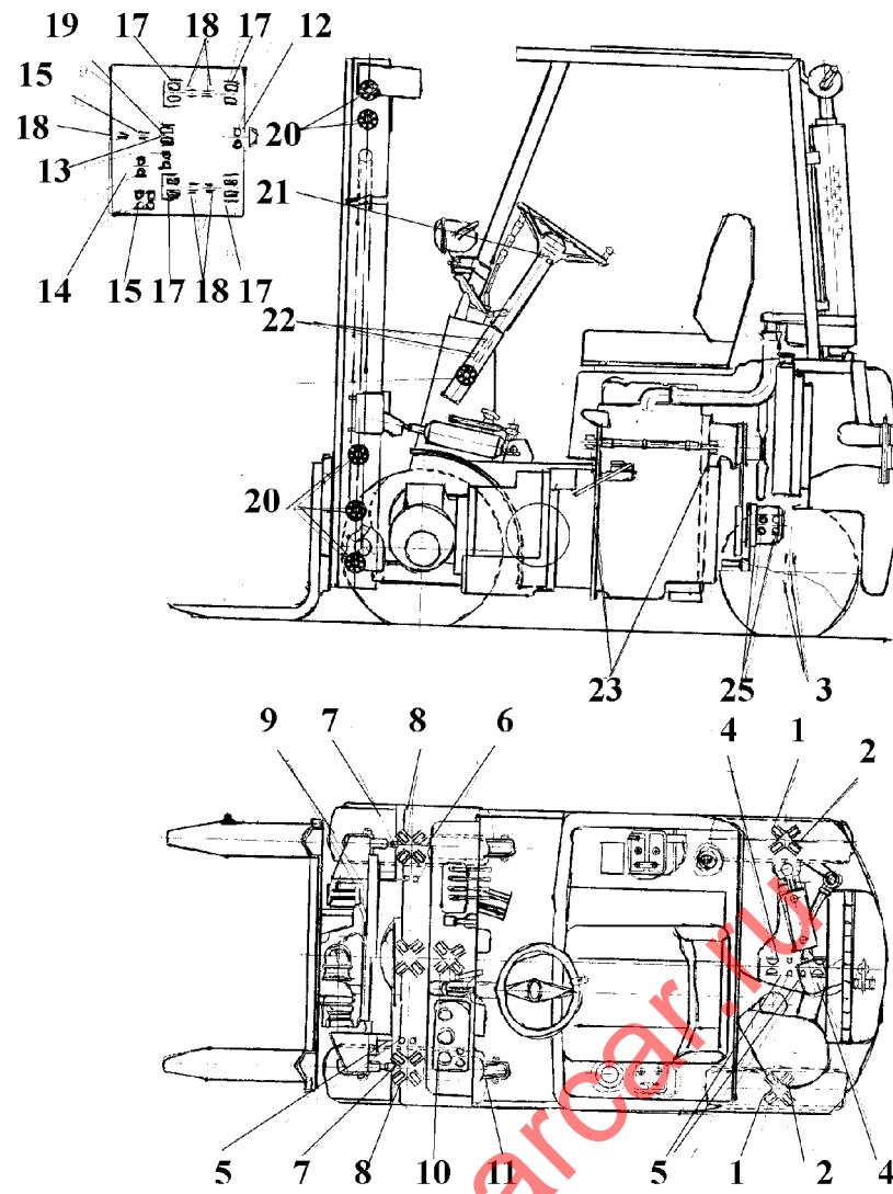
Рис. 35 Схема мест подшипников
