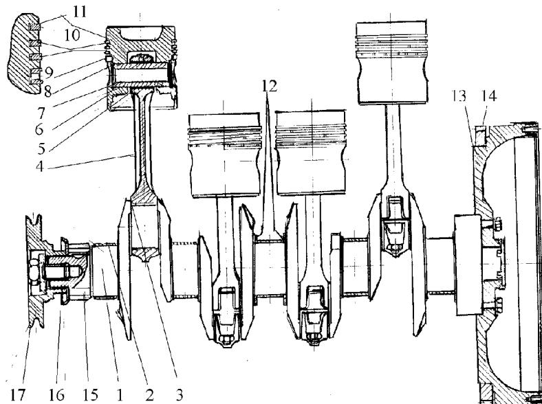
**Рис. 4 Кривошипно-шатунный механизм**
