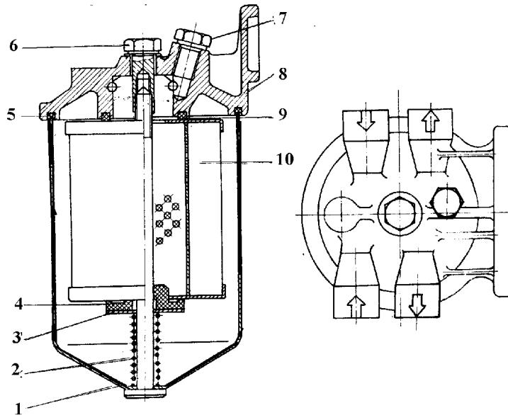
**Рис. 12 Топливный фильтр**
